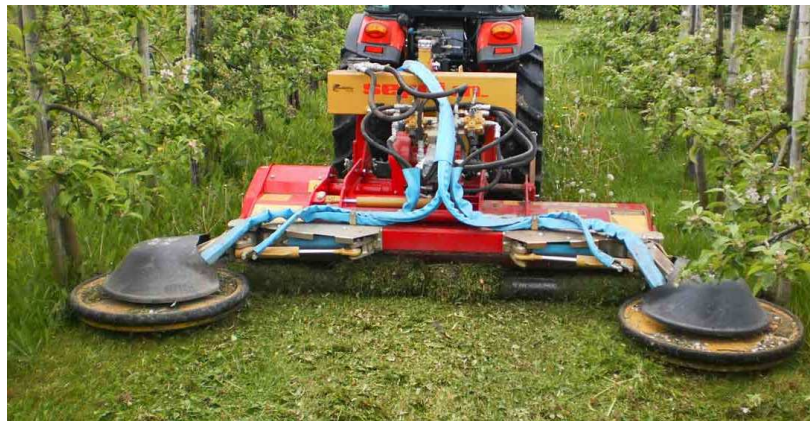
Trinciaerba con elementi laterali a disco per zona interfilare
