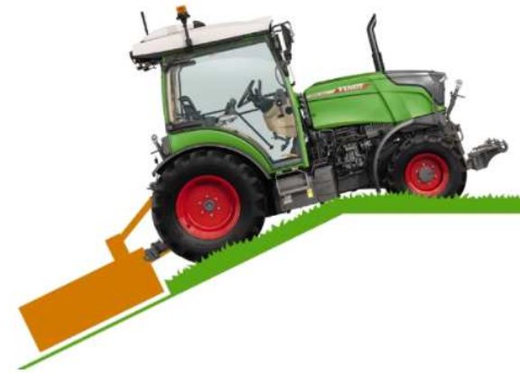
Sollevatore posteriore con modulazione della pressione.
