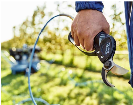
Forbici pneumatiche – diametro taglio fino a 30 mm
