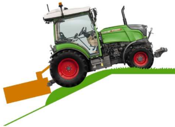
Sollevatore posteriore senza modulazione della pressione.
