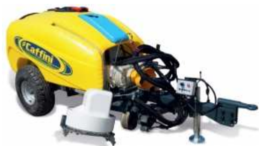
Grass Killer: effettua diserbo interfilare con getto acqua altissima pressione iniettato sotto la superficie del terreno
