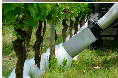
Schiumone: diserbatrice a schiuma calda
